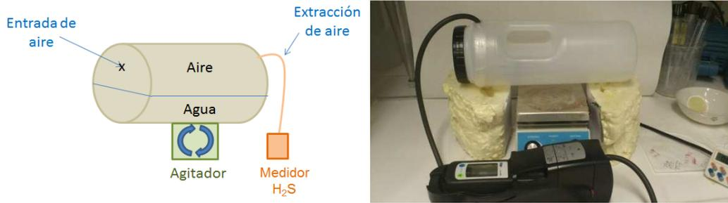
Figura 3.20 Adaptación del ensayo a pequeña escala
